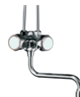
48 EX Gruppo miscelatore per boiler con canna girevole e due cannucce in rame cromato, 1/2. Lunghezza canna 15,5 cm, interasse 15 cm.
