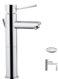
N 10 L Miscelatore monocomando lavabo alto L, su colonna. Altezza 295 mm, interasse 110 mm.
