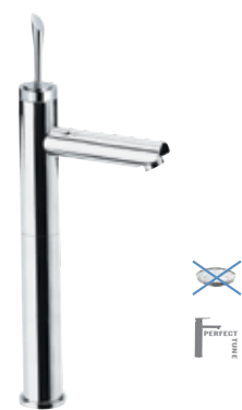
J 11 LXL Miscelatore monocomando lavabo alto LXL, su colonna, senza scarico. Altezza 390 mm, interasse 165 mm.
