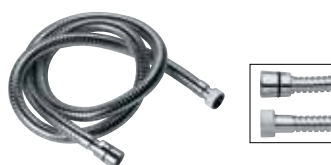
333 CN UK Flessibile per doccia a doppia graffatura in ottone cromato Ø 17 F.F., tubo in EPDM, con attacco conico.
