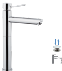
N 10 LXL B Miscelatore monocomando lavabo alto LXL, su colonna con scarico click-clack. Altezza 340 mm, interasse 180 mm.
