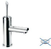
J 11 Miscelatore monocomando lavabo senza scarico. Altezza 215 mm, interasse 110 mm.
