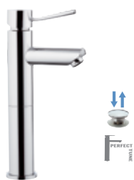
N 10 L B Miscelatore monocomando lavabo alto L, su colonna con scarico click-clack. Altezza 295 mm, interasse 110 mm.
