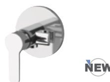
W 65 B Miscelatore incasso per shut-off su piastra in ottone cromato, attacco conico da 1/2" e supporto shut-off.
