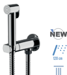
N 64 W Miscelatore shut-off con cartuccia progressiva, apertura su acqua fredda e passaggio ad acqua calda tramite rotazione di maniglia unica, comprensivo di doccetta shut-off art. 332OW e flessibile doccia cm 120.
