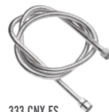
333 CNX ES Flessibile per doccia estensibile a doppia graffatura in acciaio INOX Ø 14 F.F., tubo in EPDM lunghezza cm 100, 120, 150, 175, con attacco conico.
