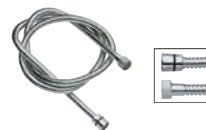
333 CN ES Flessibile per doccia estensibile a doppia graffatura in ottone cromato Ø 14 F.F., tubo in EPDM.
