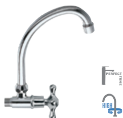
Rubinetto a snodo pesante, 1/2" canna alta "J", Ø 18, con canna girevole e rompigitto.
