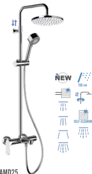
L34 AMD25 Miscelatore vasca/doccia con attacco superiore da 3/4" ed attacco inferiore da 1/2", con colonna doccia telescopica, doccetta anticalcare a 4 funzioni, con flessibile 333 CNX 150 cm e soffione minimale Ø25 cm, in ABS lusso cromato, con getti in silicone anticalcare.
