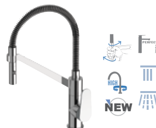
L 533 Miscelatore lavello monocomando con flessibile nero rivestito con molla "fine design" girevole 360°, con doccetta estraibile di supporto ed orientabile a due funzioni e cartuccia Ø 35.
