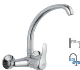
M 43 Miscelatore monocomando per lavello a muro, con leva frontale e bocca alta girevole.
