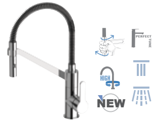
W 533 Miscelatore lavello monocomando con flessibile nero rivestito con molla "fine design" girevole 360°, con doccetta estraibile di supporto ed orientabile a due funzioni e cartuccia Ø 35.
