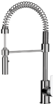
I 77 E Miscelatore monocomando lavello a molla con doccetta estraibile dal supporto ed orientabile a due funzioni e cartuccia Ø 35.
