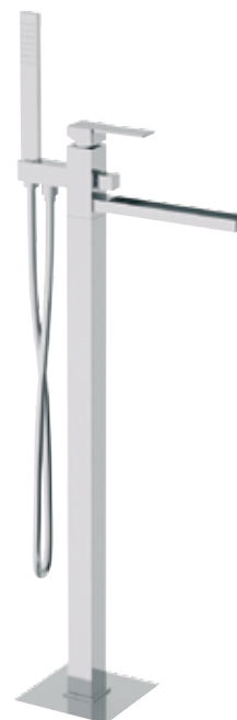
QC 08 Miscelatore vasca da pavimento, con doccetta 317RR in ottone cromato, con bocca a cascata, deviatore e kit doccia. Altezza 900 mm, interasse 183 mm.
