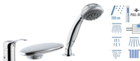
M 07 UF Miscelatore monocomando bordo vasca con deviatore integrato nel miscelatore, bocca pesante fusa con effetto a cascata e doccetta estraibile con idromassaggio e anticalcare a 4 funzioni.
