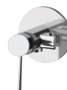
N 65 B Miscelatore incasso per shut-off su piastra in ottone cromato, attacco conico da 1/2" e supporto shut-off.
