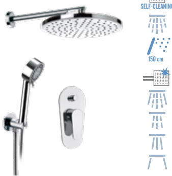
L 09 S02 Set doccia composto da: Art. 356MD20 348N30: soffione minimale in abs lusso Ø 20 cm cromato con braccio in ottone cm 30. Art. L 09L: Monocomando vasca/doccia incasso con deviatore, piastra lusso. Art. 319MO 337M: doccia duplex anticalcare a 4 funzioni con supporto presa acqua in ottone cromato e flessibile conico cm 150.
