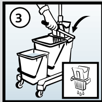
Поместить держатель с мопом в отжим вертикально вниз и надавить на рычаг до упора
